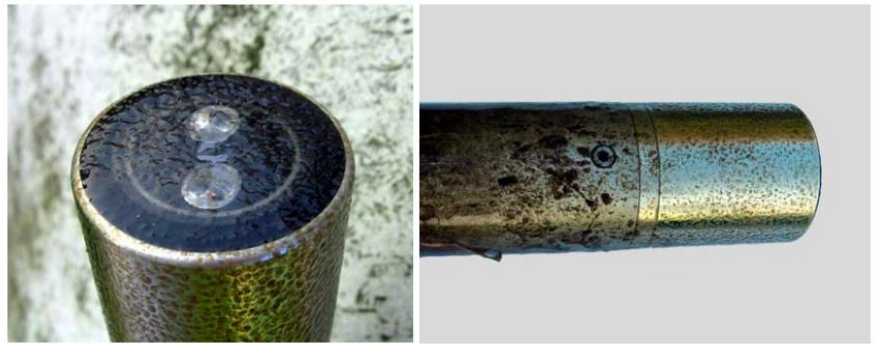
Figur 10. Begroing på on-line sensoren etter 3 dager (Straub, 2008)
