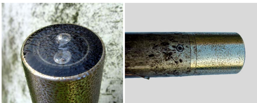
Figur 10. Begroing på on-line sensoren etter 3 dager (Straub, 2008)
