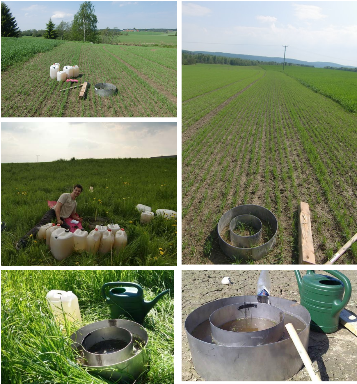
Figur 8. Bildene er fra feltforsøkene og viser bl.a. dobbelt-ring infiltrometer.
