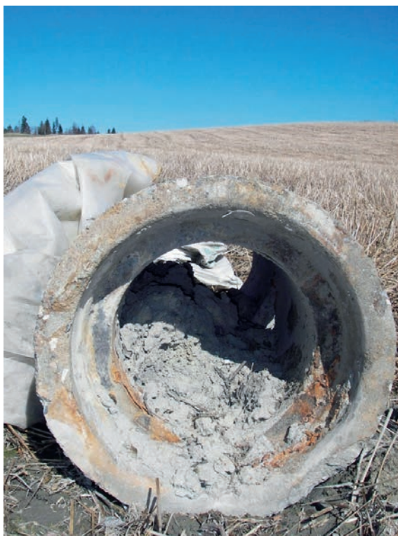
Bilde 25: Utskiftet rør fylt med leire.
