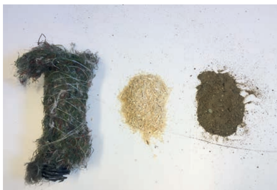
Bilde 35: De mest aktuelle filtermaterialene er sagflis, grus eller pårullet syntetisk filter. Foto Atle Hauge
