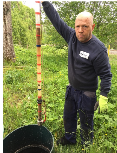
Figur 5. Slamprofil basert på data fra Cerlic-måler (venstre) og prøve tatt med slamprøverør (høyre) for det samme anlegget.
