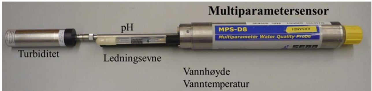
Figur 5. Multiparametersensor for automatisk overvåking av vannkvalitet.
