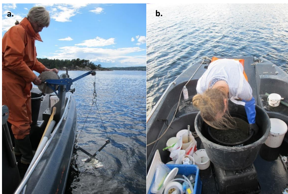
Figur 2. a. Bløtbunnsfaunaprøvetaking med håndgrabb b. Sikting av bløtbunnsfaunaprøve
