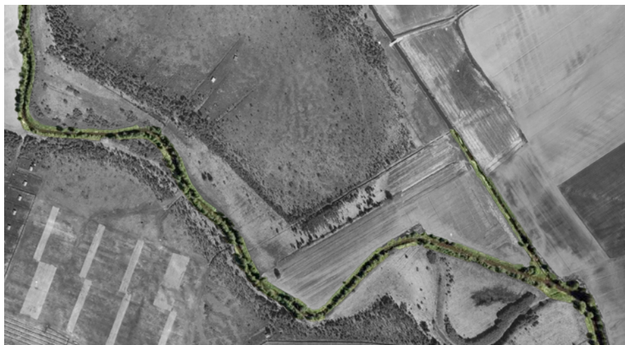
Figur 29. Tilsvarende bilde som i figur 28, dvs. med elvestrekning anno 2011 lagt oppå kartet fra 1963, men her for nedstrøms strekning. I høyre del av bildet sees en kanalisering som må ha blitt utført før 1963, da det underliggende sort-hvitt-bildet ble tatt.
