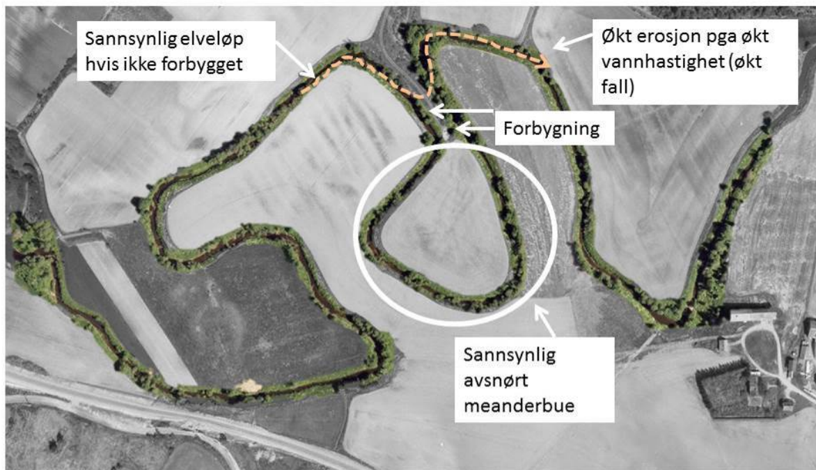
Figur 30. Kart hvor mulig forløp av elveløpet er inntegnet, forutsatt at det ikke hadde vært forbygget mot erosjon.
