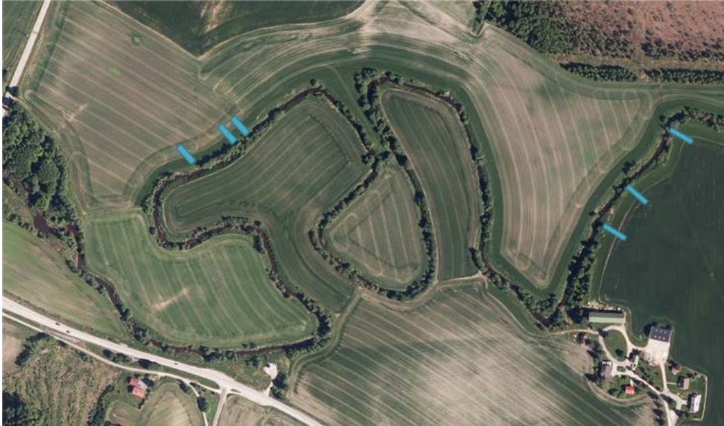
Figur 10. De seks lokalitetene hvor infiltrasjonstester ble gjennomført. Testene ble gjennomførte i åker, grasdekt vegetasjonssone og i naturlig vegetasjon mot elva.
