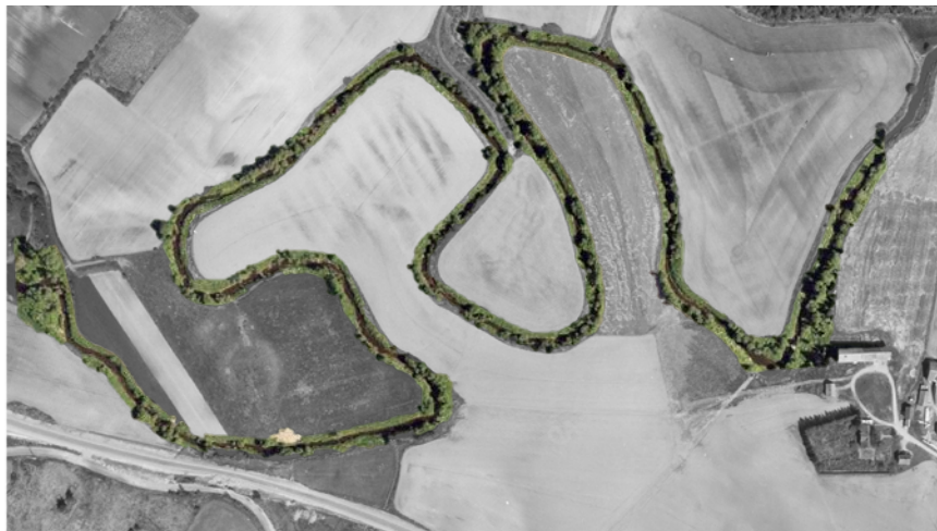
Figur 28. Sammenligning av elveløpet i 2011 (fargelagt elveløp) og i 1963 (underliggende sort-hvitt foto).
