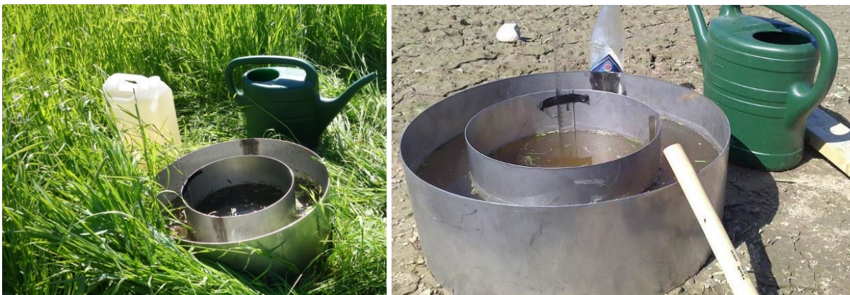
Figur 11. Bildene viser infiltrasjonsmålinger med dobbelring-infiltrometer.
